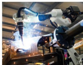
Робототехнологический сварочный комплекс
